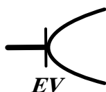
شکل ۳-۳: علامت اختصاری پریز دارای کاربری خودرو برقی
