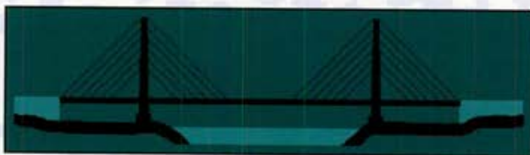
اتصال موازی کابل‌ها
