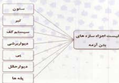
شکل ۴- لیست اجزای سازه‌های بتن آرمه
