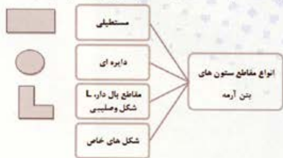
شکل ۷- انواع مقاطع ستون‌های بتن آرمه
