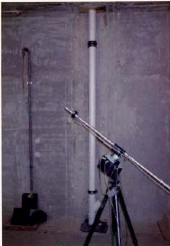
شکل ۱۷ نحوه اندازه گیری میزان انتشار صوت از سیستم لوله کشی فاضلابی طبق استاندارد EN 14366
