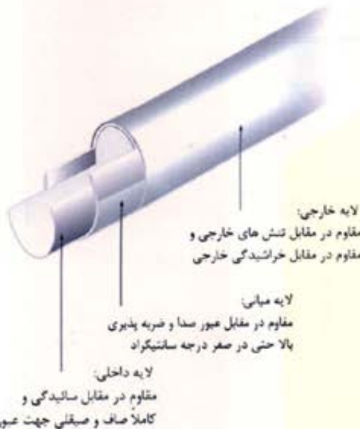
شکل ۲: ساختار لوله فاضلابی بی‌صدا
