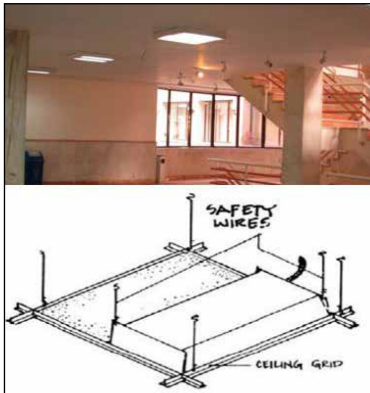
▲ تصویر ۷- اتصالات لامپ های روشنایی
