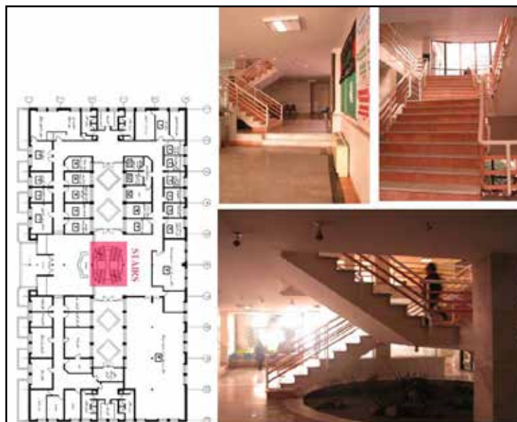
▲ تصویر ۴- پله‌های جدا از دستگاه پله - اختلال در تخلیه
