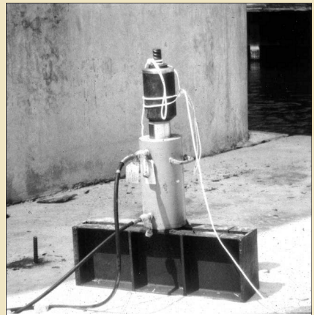
شکل ۱۵- آزمایش بیرون کشیدگی میلگرد آجدار متصل شده با رزین
