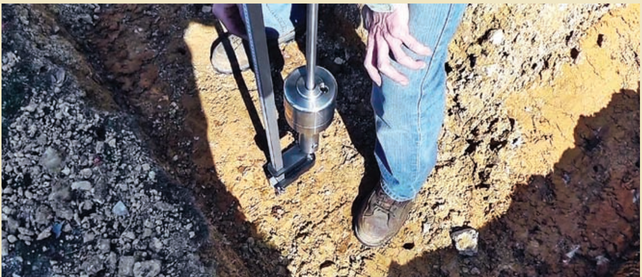
شکل ۱۵- آزمایش بیرون کشیدگی میلگرد آجدار متصل شده با رزین
