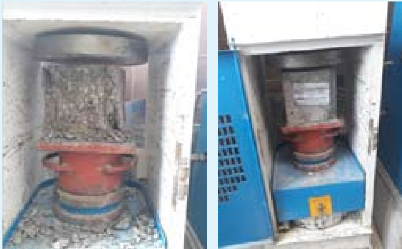
شکل (۱۱) - تبدیل شکست از حالت ترد به نرم
