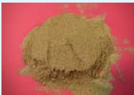
شکل (۴) - شکل ظاهری ریزدانه سبک (پومیس پودری بستان آباد)
