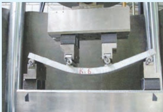
تصویر ۵- آزمایش سنجش میزان مقاومت خمشی در بتن با فناوری داکان
