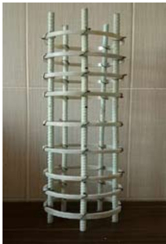
شکل ۳- نمونه ستون های ساخته شده از میلگردهای کامپوزیت پلیمری ساخت ایران
