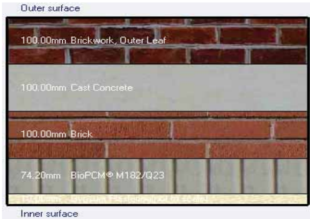
شکل ۸- چیدمان مصالح دیوار خارجی
