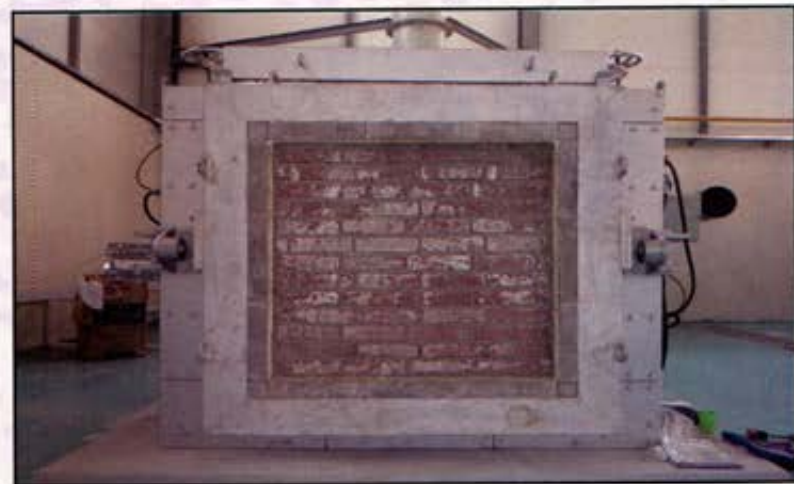
آزمایش مقاومت در برابر آتش روی دیوار یک متر مربعی (آزمایشگاه آتش مرکز)
