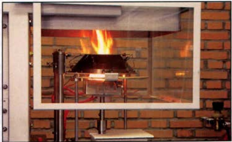
آزمایش گرماسنج مخروطی روی یک نمونه مصالح ساختمانی (آزمایشگاه آتش مرکز)
