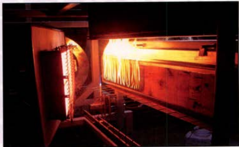
آزمایش قابلیت پیشروی شعله روی مصالح (آزمایشگاه آتش مرکز)
