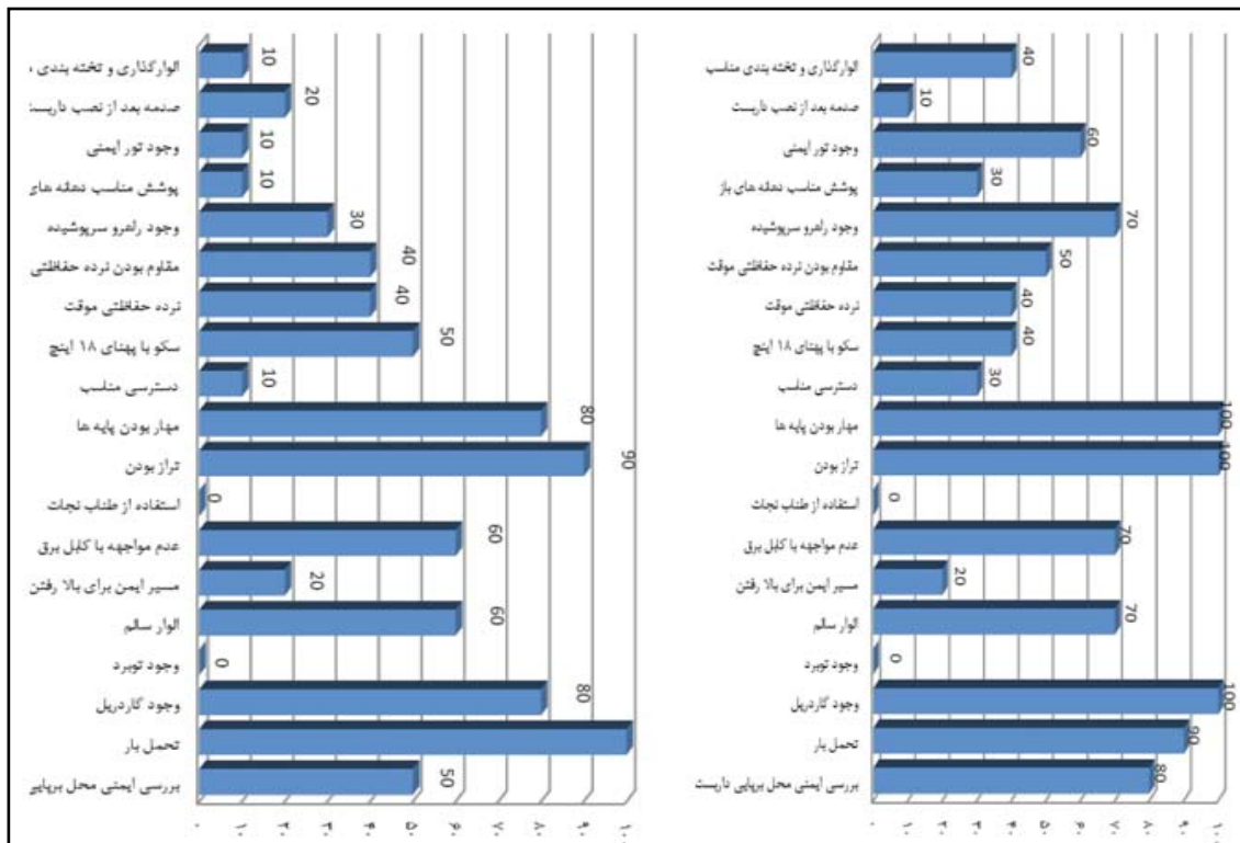
▲ شکل ۲- وضعیت ایمنی داربست ها در مناطق ۱ (سمت راست) و ۴ (سمت چپ)
