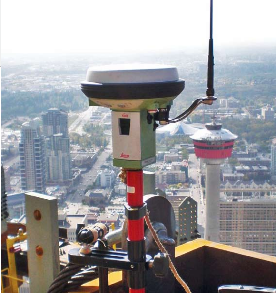
▲ کنترل شاقولی برج های بلندمرتبه با گیرنده های GPS
