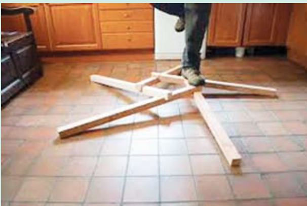
شکل (۱۵) سازه بستاروند ساخته شده با مصالح در دسترس، اتصال ساده کام و زبانه و تحمل بار
