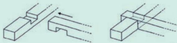
شکل (۱۲) ارتباط بین دو عضو بدون نیروی خروج از مرکز [۱]
