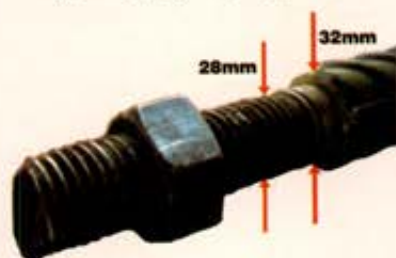
شکل ۷ - تغییر قطر آرماتور قطر ۳۲ به ۲۸ میلی‌متر در روند تهیه بولت در ایران
