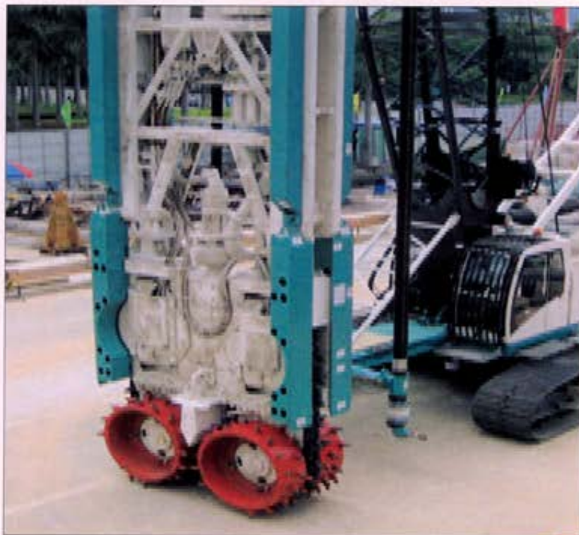
شکل شماره ۲- حفاری با استفاده از دستگاه هیدروفرز
