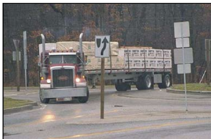
شکل ۳- تأثیر در نظر گرفتن وسایل نقلیه بزرگ در طراحی میدان [۱]
