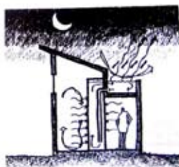
تصویر ۷- ساختمان حوض سرد. (a) عملکرد سرمایش در روز و (b) در شب
