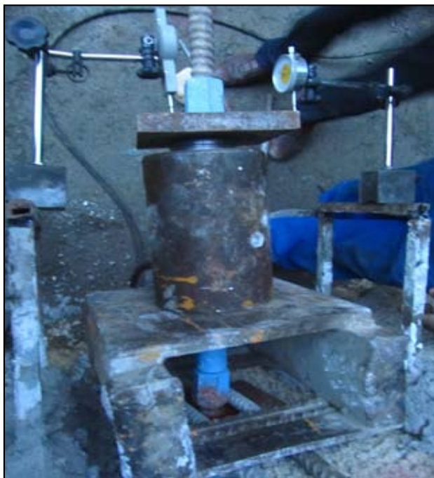
شکل ۴ - دستگاه تست کشش انکر از نوع مونو بار
