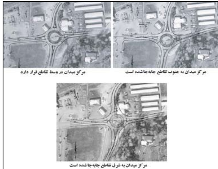
شکل ۴- سه ترکیب ممکن از موقعیت میدان و همسویی رویکرد، برای یک تقاطع خاص [۱]
