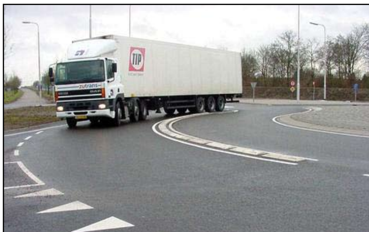
شکل ۹- تأثیر در نظر نگرفتن وسایل نقلیه بزرگ در طراحی میدان
