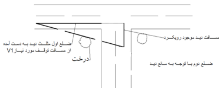
شکل ۴- نحوه اندازه گیری میدان دید تقاطع ها
