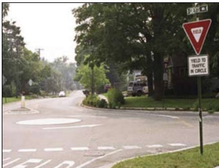
شکل ۵- حرکت چپگرد قبل از جزیره مرکزی برای وسایل نقلیه بزرگ مجاز است
