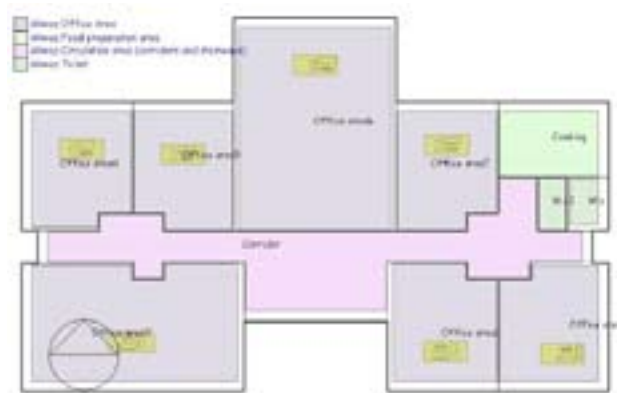
شکل ۱۲. قسمت های حرارتی ساختمان
