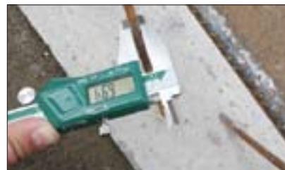
تصویر ۱۳- استفاده از میلگرد غیر فابریک
